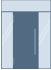
Hoja apertura interior izquierda con fijos en cada lateral y fijo superior acristalado
