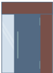
Hoja apertura interior derecha con fijos en cada lateral, izquierdo acristalado y derecho y fijo superior panelado
