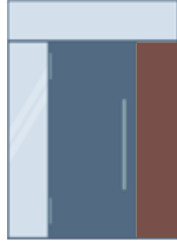
Hoja apertura interior izquierda con fijos en cada lateral, izquierdo acristalado y derecho panelado y fijo superior acristalado
